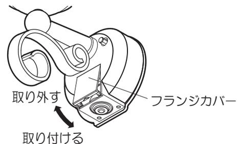
フランジカバーは必ず取り付けで使用してください。フランジカバーを取り外したまま使用すると、水が浸入し、感電・故障の原因となります。
