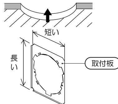
②凸部分側を天井面側とし、凸部分が天井裏に乗り上げないように配置する。
