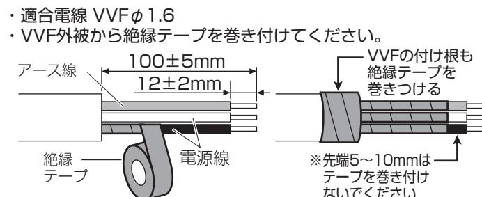
(注意)VVFΦ2.0は電線が硬いため、器具が浮き上がり、正しく設置できない場合があります。
