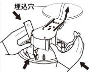
石こうボードから器具を 取り外す場合は、天井材の 破損にご注意ください。 枠部をゆっくり引き下げ、 取付バネを押し曲げながら 取り外してください。 取り外しに不備があると、 天井材破損の原因となる ことがあります。
