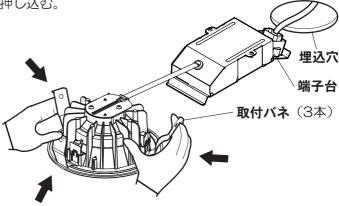
●石こうボードに取り付けた器具を取り外す場合は、 枠部をゆっくり引き下げて取付バネ(3本)を 押し曲げながら取り外してください。 取り外しに不備があると、天井材破損の原因となる ことがあります。
