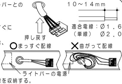
不備があるとライトバーの電源と干渉し電源線損傷による感電・火災の原因となります。
