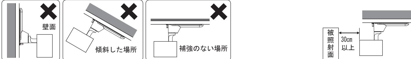
●器具と被照射面の距離は、30cm以上離す。被照射物の火災・変色の原因となります。
