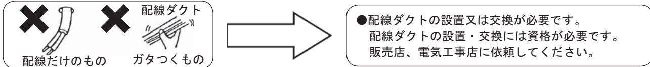
●天井取り付け専用器具です。下図のような場所に取り付けると器具の火災・感電・落下の原因となります。
