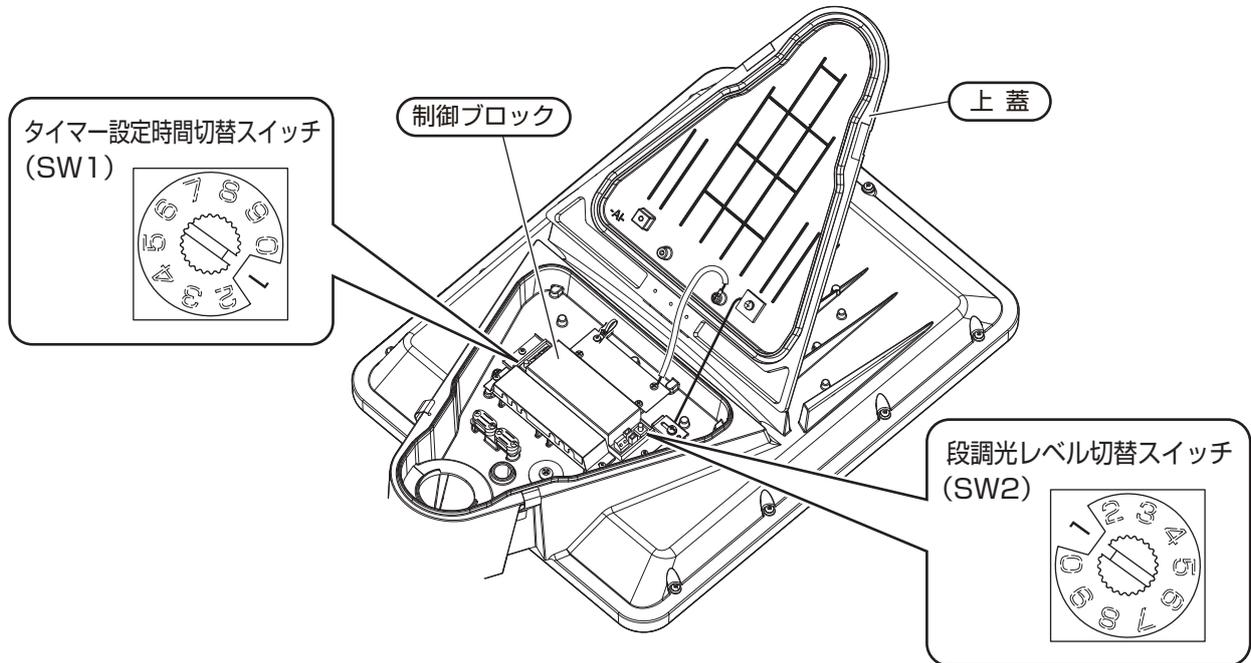
段調光レベル切替スイッチを設定後、電源を投入してください。
