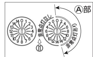
注) 蓄電池による点灯可能時間は設置地域の日射量により異なりますので別表の地点別点灯可能時間一覧表を参考に設定してください。点灯可能時間以上の点灯時間を設定すると短期間に蓄電池が空になり所定の時間点灯できないばかりでなく蓄電池の大幅な寿命低下の原因となります。蓄電池点灯終了後の商用電源による点灯時間は任意に設定可能です。
