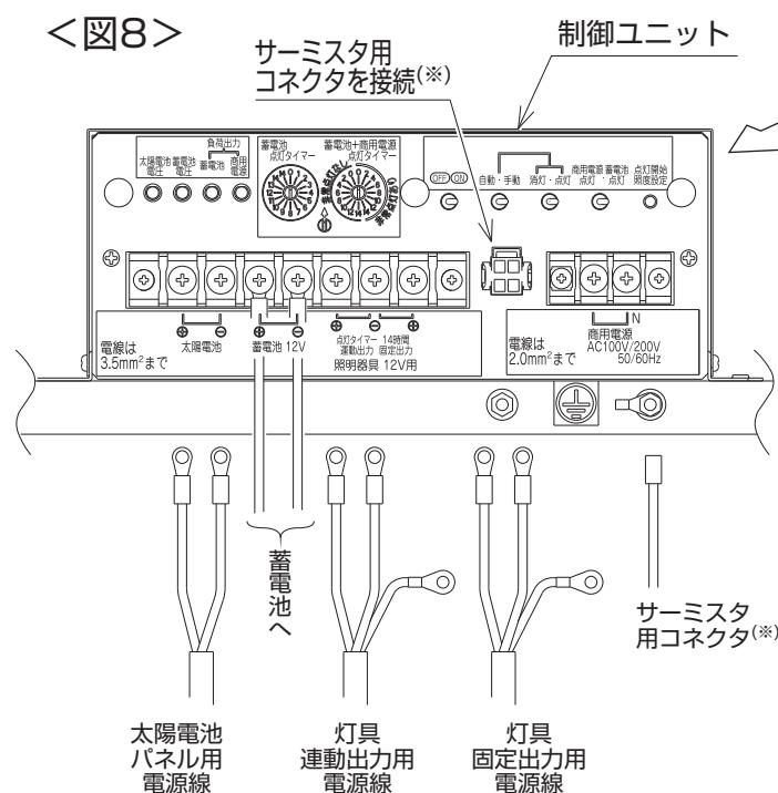
※) サーミスタ用コネクタは蓄電池を設置してから接続してください。サーミスタ電線は線径が細いため断線する原因となります。
