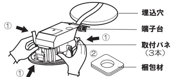
●石こうボードに取り付けた器具を取り外す場合は、枠部をゆっくり引き下げて取付バネ(3本)を押し曲げながら取り外してください。取り外しに不備があると、天井材破損の原因となることがあります。
