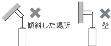
◎この器具は配線ダクト水平天井吊り下げ専用です。
