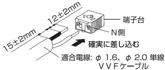
器具の取り替えなどで電源線を外す場合はマイナスドライバーなどを解除穴 (2カ所) に差し込みながら電源線を引き抜く。
