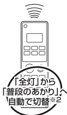
※2: 設定時刻にリモコンから切替信号を自動で送信します
