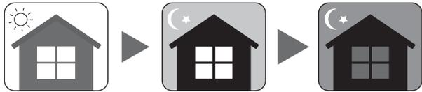
●るすばんモードはOFFにするまで毎日繰り返します。在宅を装うため、点灯・消灯時刻は「設定通り」、「15分前」、「30分前」の3パターンでランダムに変わります。(設定日は「設定通り」で動作します)
