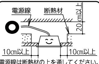
電源線は断熱材の上を通してください。
