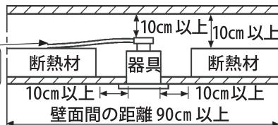
断熱施工されていない天井に取り付ける場合
