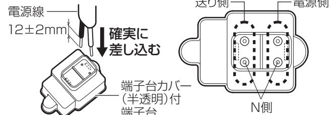
器具の取り替えなどで電源線を外す場合は、マイナスドライバーなどで解除ボタンを押しながら電源線を引き抜く。
