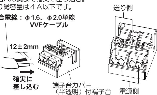
器具の取り替えなどで電源線を外す場合はマイナスドライバーなどで解除ボタンを押しながら電源線を引き抜く。
