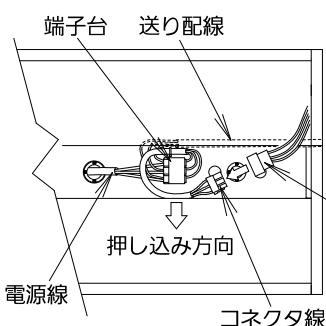
施工時にコネクタの水色両面テープの剥離紙を剥がして本体側に固定する。
