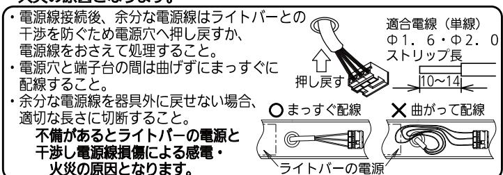
・器具内の送り配線はできません。電源線の器具間送り配線は、電源線を天井裏に戻し配線してください。
