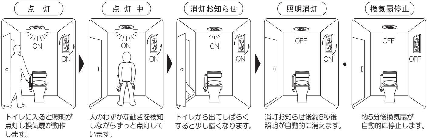
トイレに入ると照明が点灯し換気扇が動作します。
