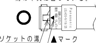
▲マークが給電側ソケットの溝の中央に合っていない。
