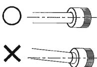
⑤の注意点：給電側ソケットの回転部分が下図の位置にあることを確認する。
