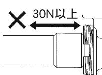
⑦の注意点：ソケットキャップとソケットにスキマが出ないよう締め付ける。
