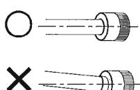
①の注意点: 給電側ソケットの回転部分が下図の位置にあることを確認する。
