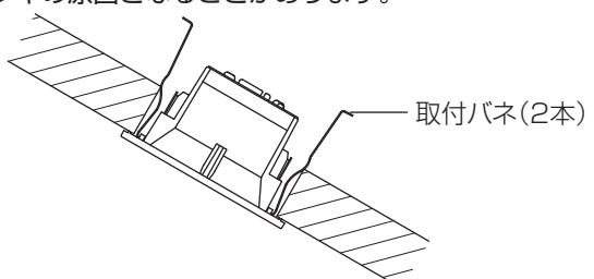
●石こうボードに取り付けた器具を取り外す場合は、枠部をゆっくり引き下げて取付バネ(2本)を押し曲げながら取り外してください。
