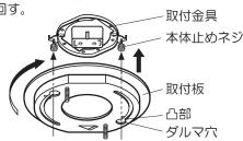
③ドライバーで本体止めネジを締め付ける
