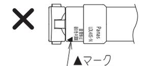
・発光部が照射側となるように、90°回転させて取付ける。
