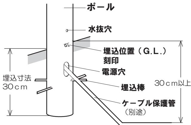
直接埋込式により、車両その他の重量物の圧力を受ける恐れのない場合の施工例です。
