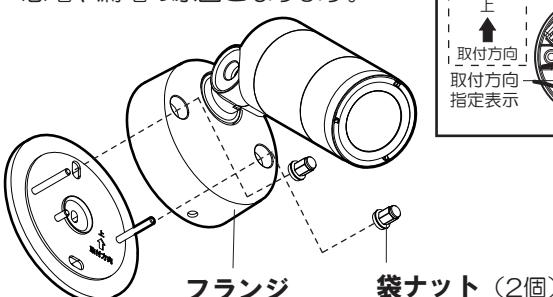
袋ナット（2個）を工具で確実に締め付けてください
