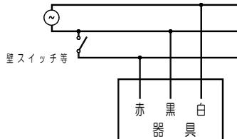
※器具端子台の短絡線を取り外して配線してください。
