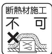
電源線は器具に触れず、断熱材上に施工する
