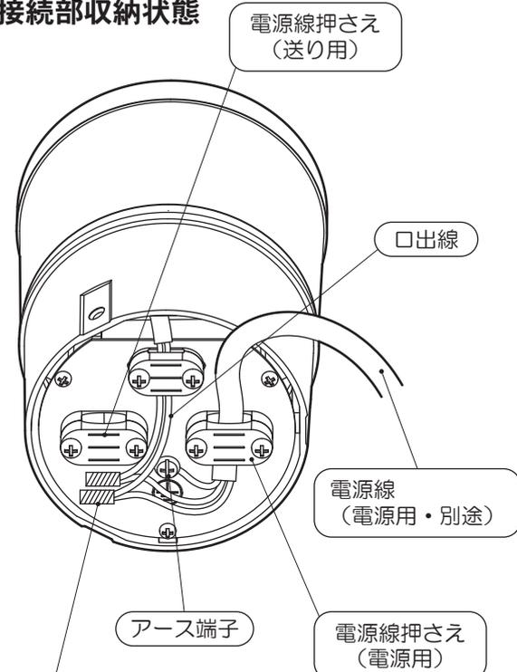
接続部をスリーブなどで結線後、自己融着テープを巻いてから、絶縁テープを巻いて仕上げ、十分に絶縁・防水処理を行ってください。
