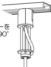
**確認** 取り付け後、ストッパーを下げるずに回し、外れないことを確認してください。
