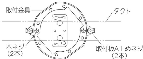
◎普段使用するダクトの向きと取付板A止めネジが“平行”となるように取付金具を取り付けてください。
