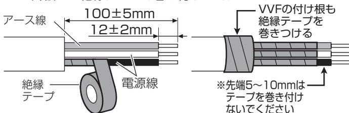
(注意) VVFφ2.0は電線が硬いため、器具が浮き上がり、正しく設置できない場合があります。
