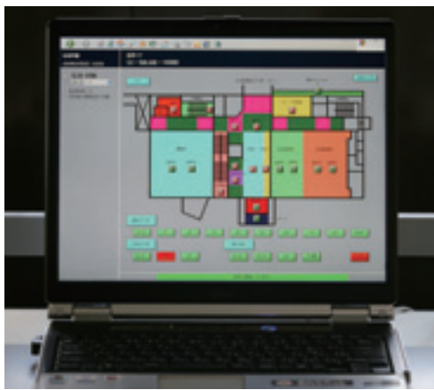
▲隣接するキャンパスの受付のパソコンからも照明監視・制御、電力量、給水量などの確認が可能
