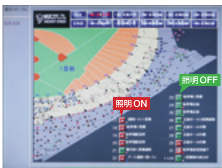
▲1階1塁側内野のモニター。 オリジナルの照明器具アイコンで点滅状態を一目で確認
