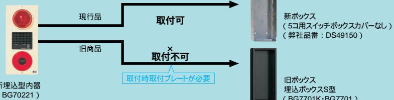
既設のBG70121、BG70141、BG70141KおよびBG70161を新複合装置埋込型内器( BG70221 )に取り替える場合、取付プレートが必要です。
