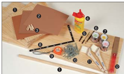
【木材・用具】①木材(ラジアタバイン集成材、ラジアタ丸棒) ②サンドペーパー ③木製タボ(直径10mm・長さ45mm) ④木工用ボンド ⑤ドライバービット(木工用、下穴あけ用、プラス) ⑥鉛筆 ⑦水性ペイント(イエロー、ピンク、オリーブ) ⑧カネジャック ⑨メジャー ⑩木ネジ(51mm) ⑪ハケ ⑫ノコギリ
