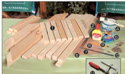
【木材・用具】 ①木材(1×2、1×4 SPFランバー) ②木工用ボンド ③ハケ ④ガーデニング塗料(カラーステインなど) ⑤メジャー ⑥サンドペーパー ⑦カネジャク ⑧ドライバービット(下穴あけ用、プラス) ⑨鉛筆 ⑩木ネジ(30mm、75mm) ⑪クランプ
