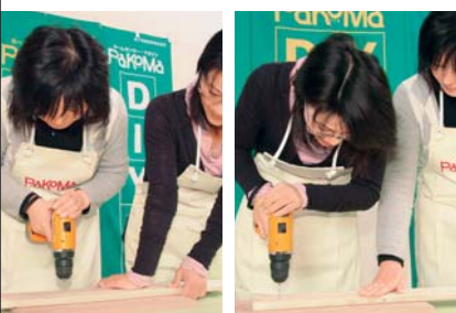
ドリルドライバーの正しい使い方のポイントは、木の面に刃を垂直に当てること。
