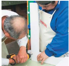
座板の前部下に、座板受けの横木を取り付ける。
