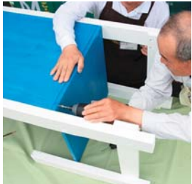
座板の前部下に、座板受けの横木を取り付ける。
