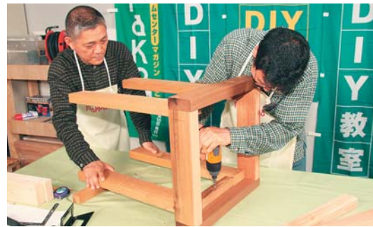
インパクトドライバーを使えば、長い木ネジ締めもラク。
