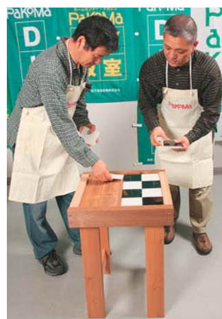
天板の上にタイルを並べて、カフェテーブルの完成!
