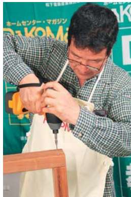
インパクトドライバーを使えば、長い木ネジ締めもラク。
