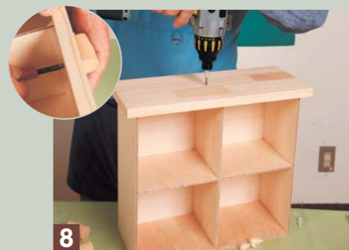
8 下段の引き出しを作る。底板のセンター位置に印を付け、十字の仕切り板を木工用ボンドで付ける。引き出しの角に補強用の三角材を接着する。ラミン丸棒でツマミを作り、裏面から木ネジで締めて取り付ける。
