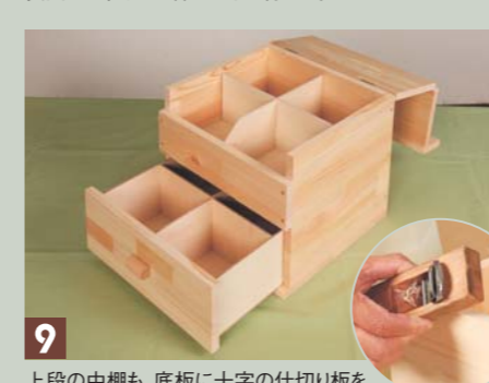
9 上段の中棚も、底板に十字の仕切り板を接着して、棚受けにのせる。最後に、木の角を豆カンナで軽く面取りし、全体にサンドペーパーをかけて完成。
