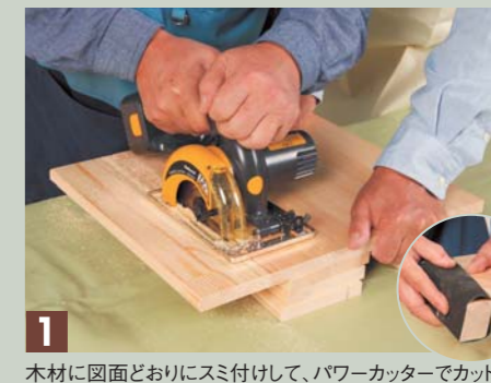
1 木材に図面どおりにスマ付けて、パワーカッターでカットする。(ホームセンターでカットしてもらえると便利。カットした後の木口を、サンドペーパーで磨いておく。
