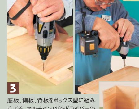
3 底板、側板、背板をボックス型に組み立てる。マルチインパクトドライバーの下穴用ビットで下穴をあけてから、インパクトドライバーで木ネジを締める。
