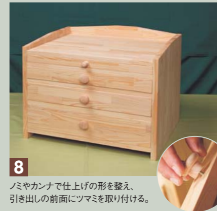
ノミやカンナで仕上げの形を整え、引き出しの前面にツマミを取り付ける。
