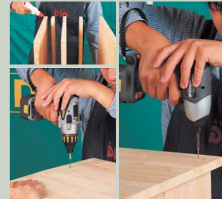
ラックの側板と棚板を付ける部分に、ダボ処理をする丸穴を木工用ビットであける。(マルチインパクトドライバー使用)
