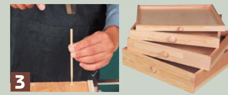
引き出しを組み立てる。(木工用ボンドで接着し→隠しクギで仮止め→ハタガネで固定→完全に接着したら底板をはめる→木のクギ打ち) 同じ工程で4個の引き出しを組み立てる。
