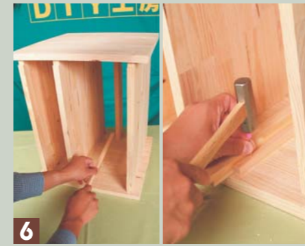
引き出し受けの角材を左右2段分付ける。カンナで軽く面取りしてから木工用ボンドで接着し、隠しクギで固定する。
