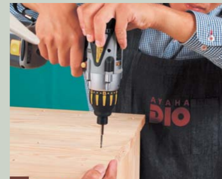
ラックの側板と棚板を付ける部分に、ダボ処理をする丸穴を木工用ビットであける。(マルチインパクトドライバー使用)
