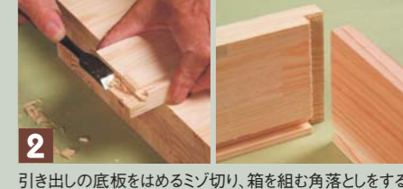
引き出しの底板をはめるミゾ切り、箱を組む角落としをする。
