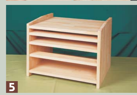
側板と天板、棚板、底板を付ける。木工用ボンドで接着してから、マルチインパクトドライバーの下穴あけ用ビットで丸穴のセンターに下穴をあけ、インパクトドライバーで木ネジを締める。
