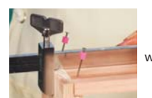
◎接着した面に「隠しクギ」を打ち、完全に接着した後、ペンチなどで引き抜く。
