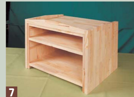
天板の上に山形の板を木工用ボンドで取り付け、ラック本体の後側の左右角に、背板固定用の角材を木工用ボンドで取り付け、背板をはめる。
