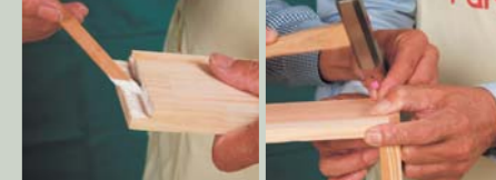
引き出しの底板をはめるミゾ切り、箱を組む角落としをする。
