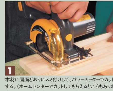
木材に図面どおりにスミ付けて、パワーカッターでカットする。(ホームセンターでカットしてもらえるところもあります)。カットした後の木口をサンダーで磨いておく。
