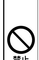
禁止         | <ul style="list-style-type: none"> <li>当社充電工具専用の指定の充電式電池パック以外を使わない。</li> <li>電池パックは、火への投入、加熱をしない。</li> <li>電池パックに釘を刺したり、衝撃を与えた後、分解・改造をしない。</li> <li>電池パックの端子部を金属などで接触させない。</li> <li>電池パックを釘などの金属と一緒に持ち運んだり保管しない。</li> <li>電池パックを火のそばや炎天下など高温の場所で充電・使用・放置をしない。<br/>発熱・発火・破裂のおそれがあります。</li> </ul> |
