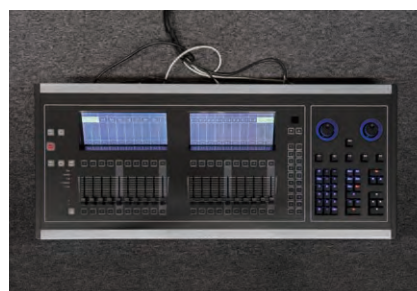
バックアップ照明操作卓
