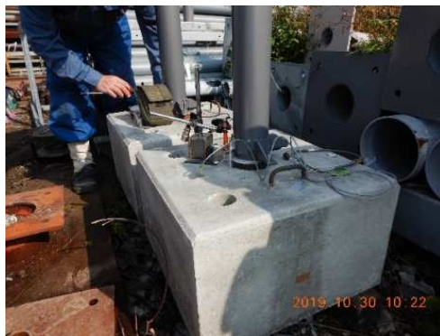
写真3 試験体 (奥錆あり、手前錆なし)
