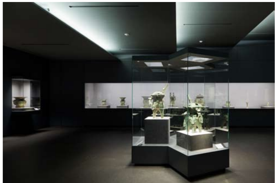
2階青銅器展示室。天井は段状に重なり傾斜しており、コーブ照明で照らされている。
