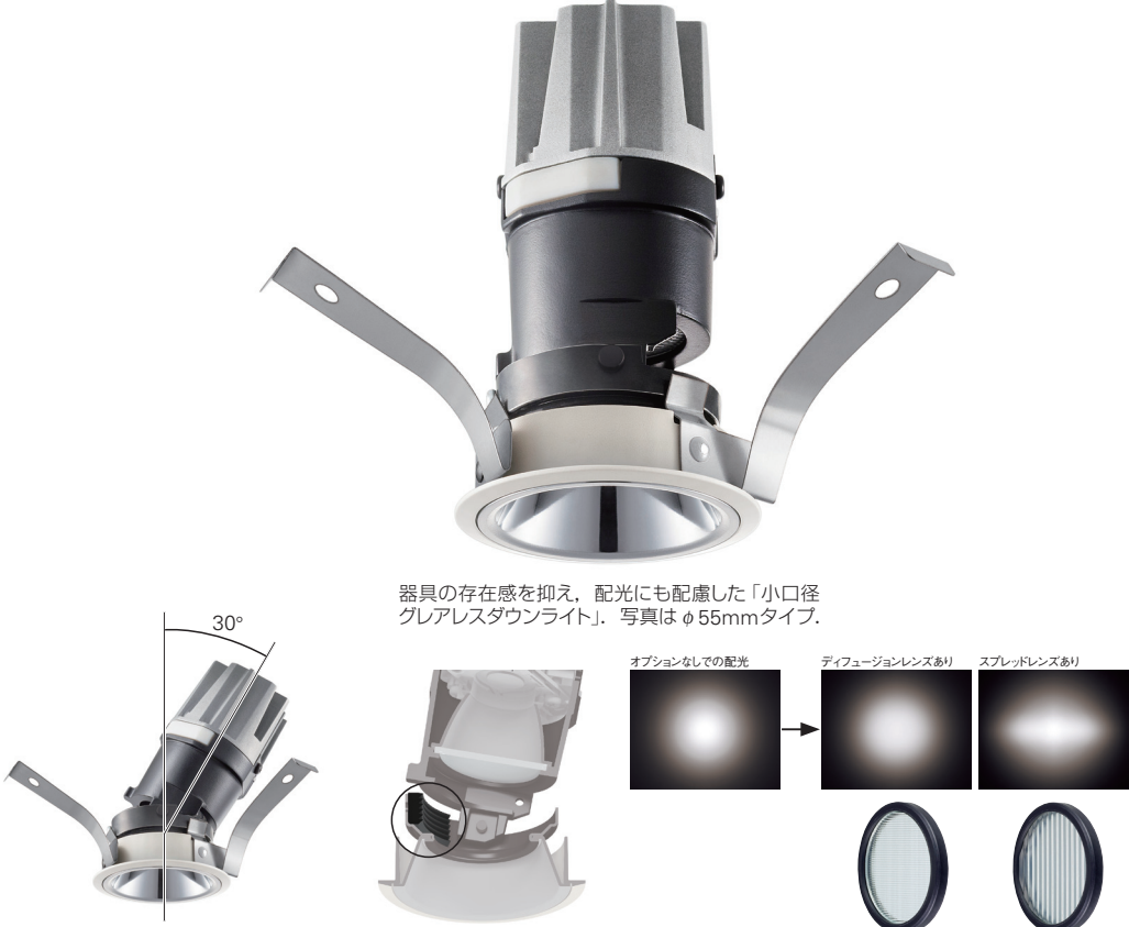
器具の存在感を抑え、配光にも配慮した「小口径グレアレスダウンライト」。写真はφ55mmタイプ。 ユニバーサルタイプは30°首振りが可能。配光角はφ55タイプが3種、φ75タイプが4種から選べる 首振り時のグレアにも配慮したバッフルパーツを装備。 オプションで各種レンズを取付可能。 オプションなしでの配光 ディフュージョンレンズあり スプレッドレンズあり
