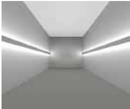
検討段階。シームレス照明を使用。 空間全体に光が回らず、明るさ感が不足。 Feu値：3.0、平均床面照度：79.8lx。
