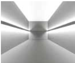
検討段階。SmartArchi使用。 天井面だけが過度に明るい。 Feu値：7.7、平均床面照度：292lx。
