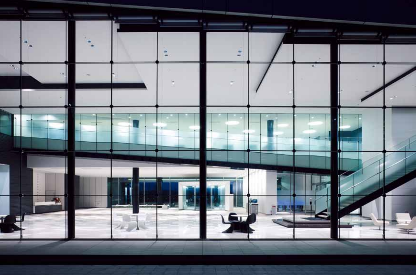
中庭よりエントランスホールを見る。屋は自然光が入ることから照明は最低限に抑えている。奥に見える2階カフェスペースの天井は、折り上げ部分が光るように奥に灯具を設置している。
